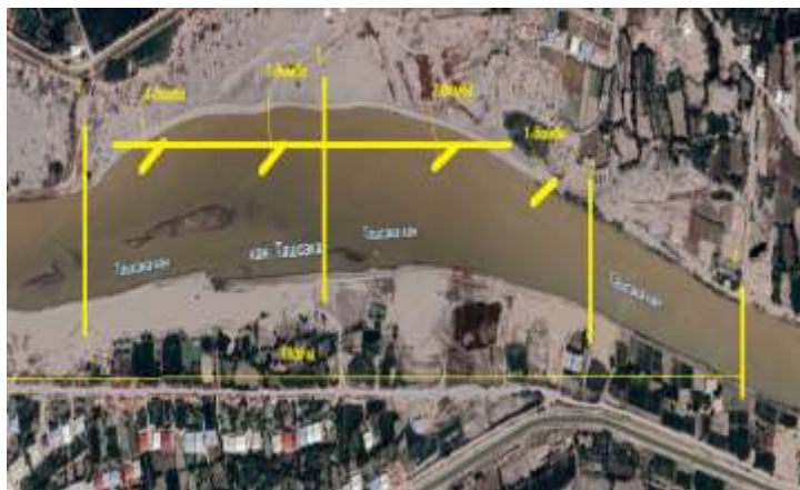
7-расм Канал узунлиги бўйича химоя бошқарув дамбалар ўрнатиш схемаси
