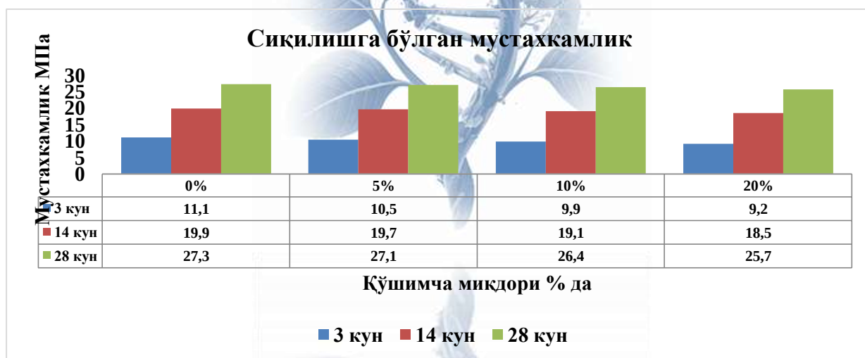
5-расм. Учувчан кул ва мис эритиш саноати чиқиндисини биргаликда қўшиб комплекс тарзда тайёрланган намуналарнинг эгилишга бўлган мустаҳкамлигини а таъсири
