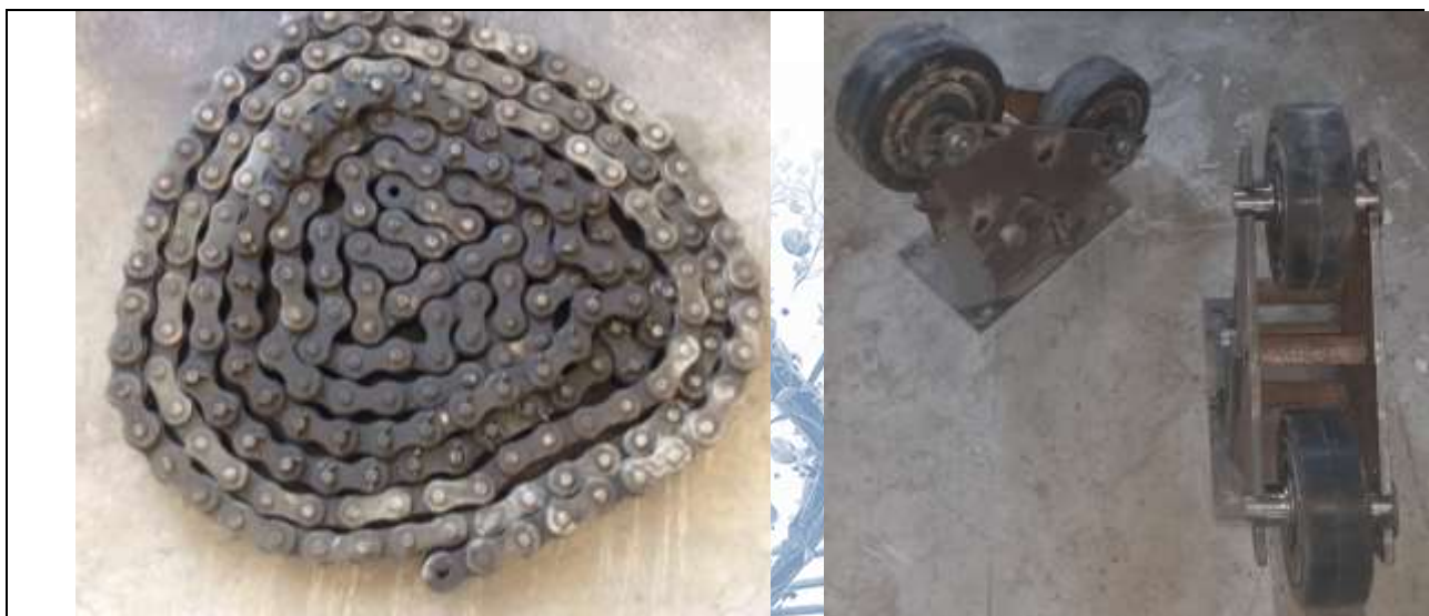
Рисунок 5. Общий вид цепи необходимой длины и роликовых опор
