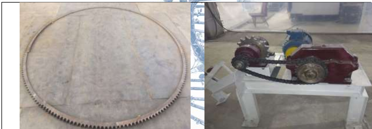
Рисунок 4. Фрагмент процесса изготовления зубчатого венца и ведущего цепного привода
